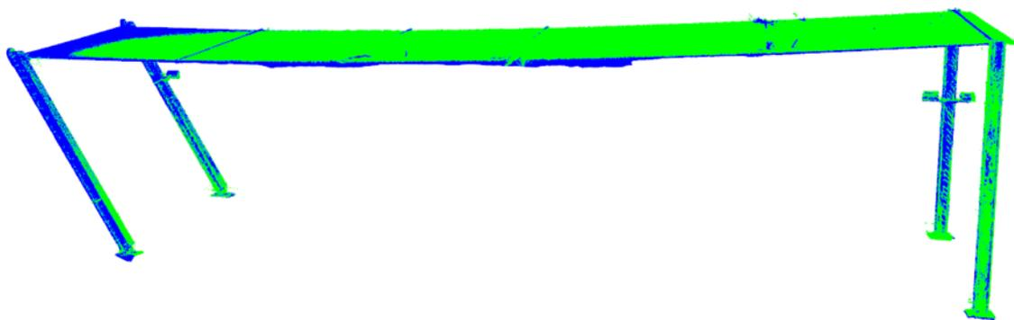
Figura 48: Modelo fusão LiDAR e fotogrametria em nuvem de pontos (verde– nuvem LiDAR, azul – Fotogrametria).
