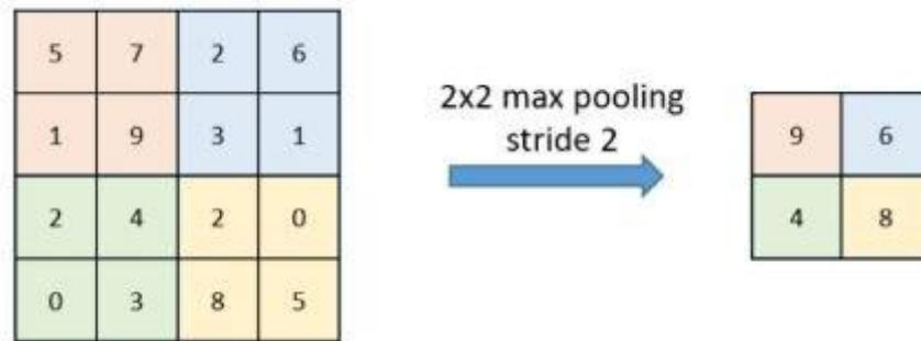
Figura 28: Exemplo de atuação de uma camada max pooling (adaptado de Almeida et al., (2020)).
